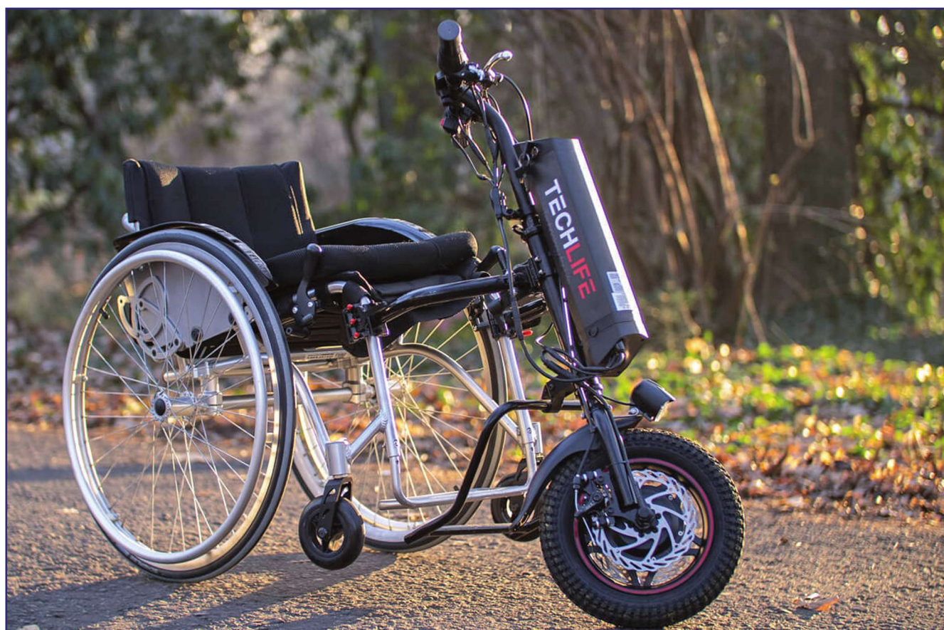
Posiadanie dwóch wózków inwalidzkich – ręcznego i elektrycznego – może być niepraktyczne. Alternatywą może być posiadanie jedynie wózka ręcznego i zakup napędu elektrycznego takiego jak Techlife W1. Fot. techlife.pl
