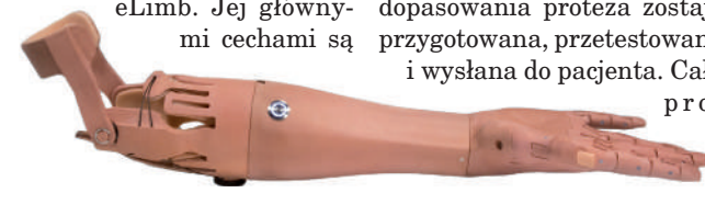
Proteza TrueLimb jest wykonana przy użyciu druku 3D. Fot. unlimitedtomorrow.com
