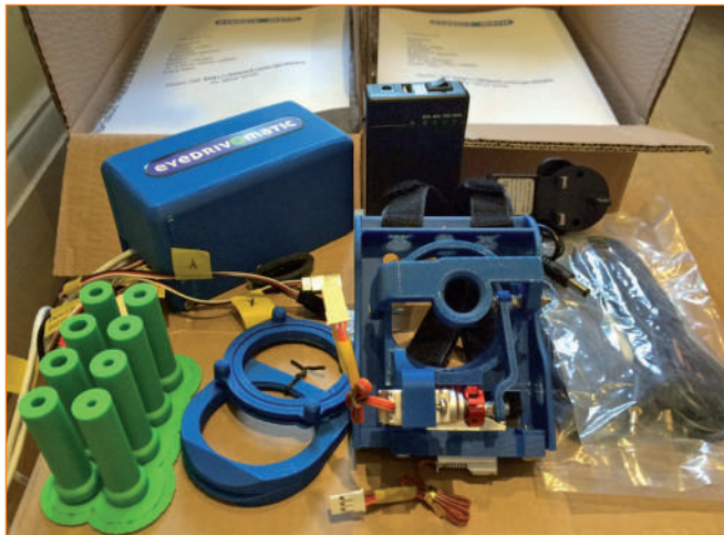
Eyedrivomatic to system, który umożliwia sterowanie elektrycznym wózkiem inwalidzkim przy użyciu ruchu oczu. Fot. eyedrivomatic.org
