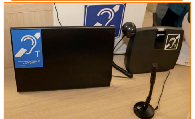
W Izbie Przyjęć pojawiły się urządzenia ułatwiające kontakt z osobami niedosłyszącymi. Pętla indukcyjna pozwala na przesyłanie dźwięku bezpośrednio do aparatu słuchowego.
