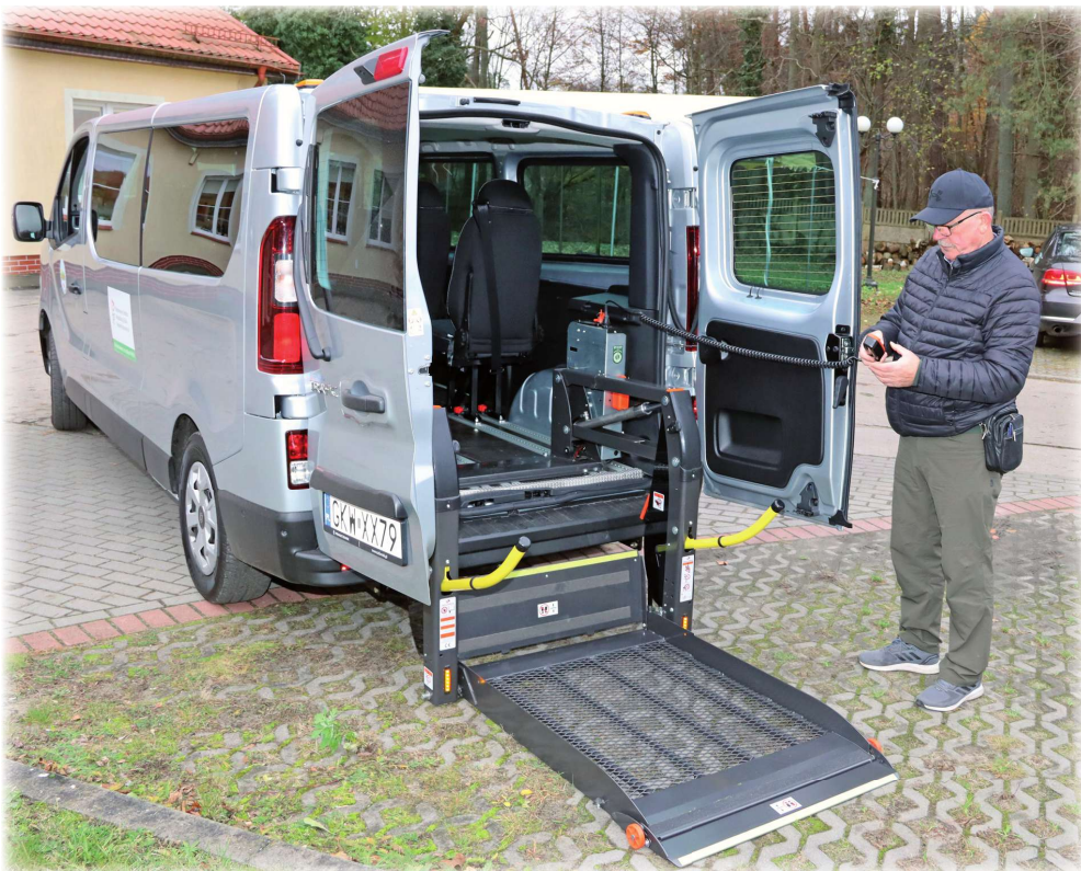
► Pojazd może przewozić dziewięć osób, w tym dwie na wózkach inwalidzkich, gdyż został wyposażony w windę.
